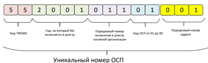
Рисунок 283. Структура обозначения кода подразделения ОСП
